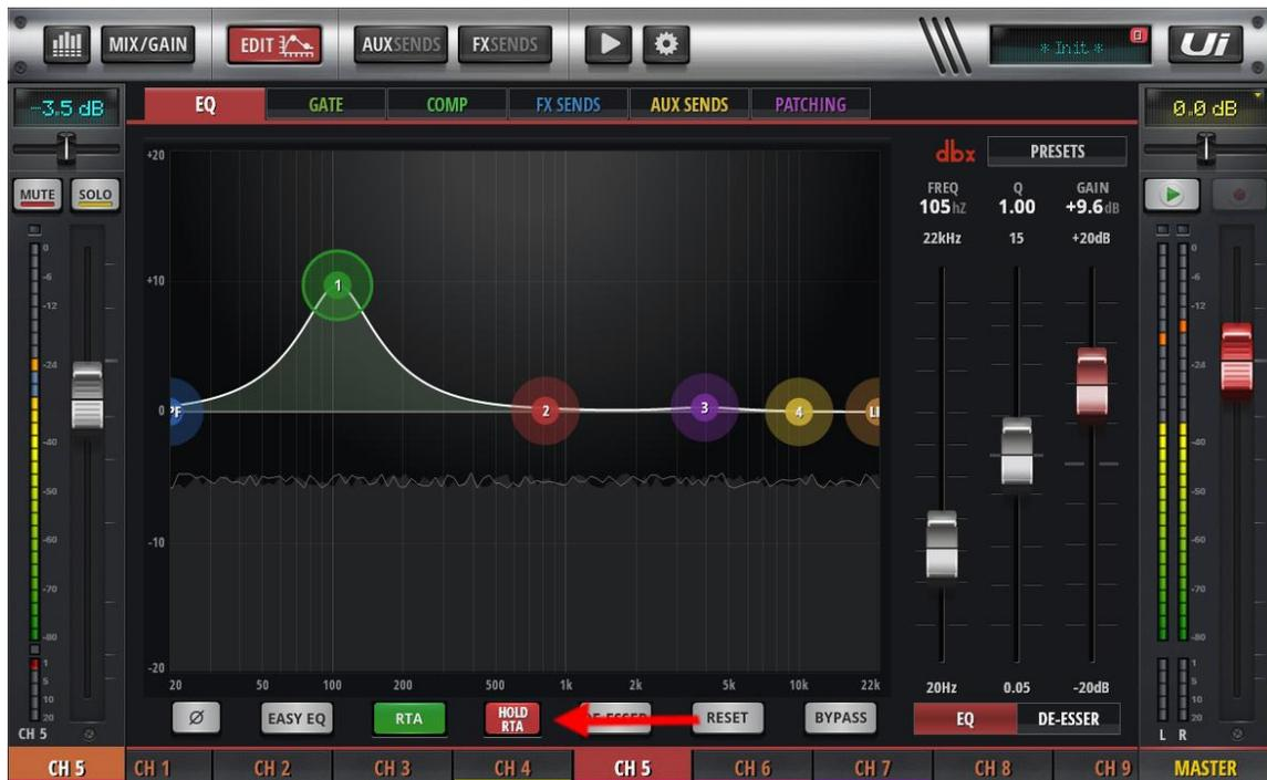
Cliquer sur le bouton « HOLD RTA » va créer et conserver un pourtour de la fonction RTA à l'écran, ce qui vous permet ensuite de voir les changements d'allure du RTA lorsqu'une EQ est appliquée. Aussi, cela prend part à la section suivante qui permet à l'utilisateur de voir la fonction RTA d'un canal sur la page « MASTER EQ ».
