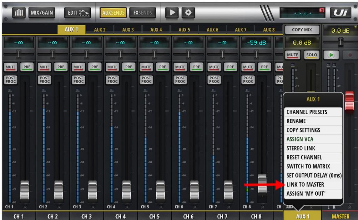
Le fader du AUX/MTX suit maintenant la position du fader MASTER.
