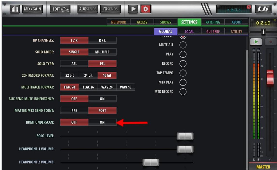
Pour les écrans HDMI directement connectés à l'Ui24R qui ne se redimensionne pas correctement et qui n'ont pas de paramétrage interne pour ajuster la taille de l'écran, un simple paramètre « d'overscan » a été ajouté. L'activation de celui-ci se fait sous l'onglet « GLOBAL » de la page « SETTINGS ».
